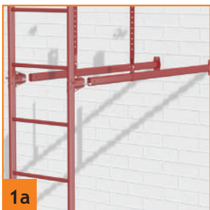
Установка подвесных кронштейнов с креплением к стропилам
