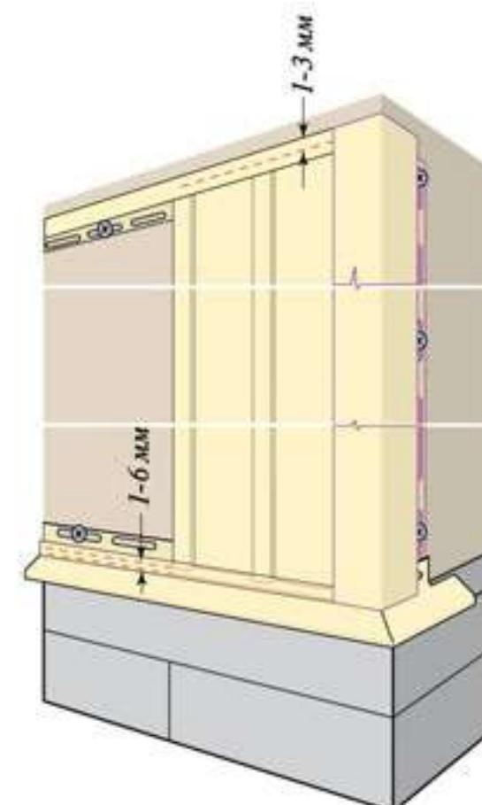
При монтаже вертикального сайдинга на цоколь дома вместо стартовой планки устанавливают отлив и/или окантовочный профиль, поверх устанавливается J-профиль, окантовочный профиль или молдинг. Крепится вертикальный сайдинг по аналогии с углами и Н-профилем.
